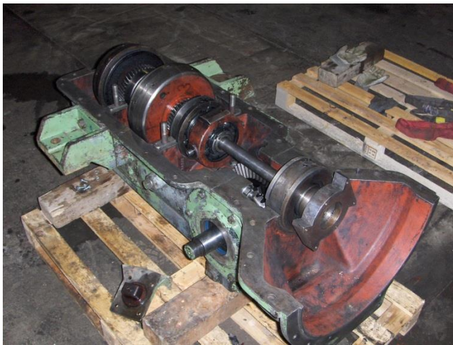
Das Revidierte Getriebe nach dem Zusammenbau Bild: Remo Hartmann
